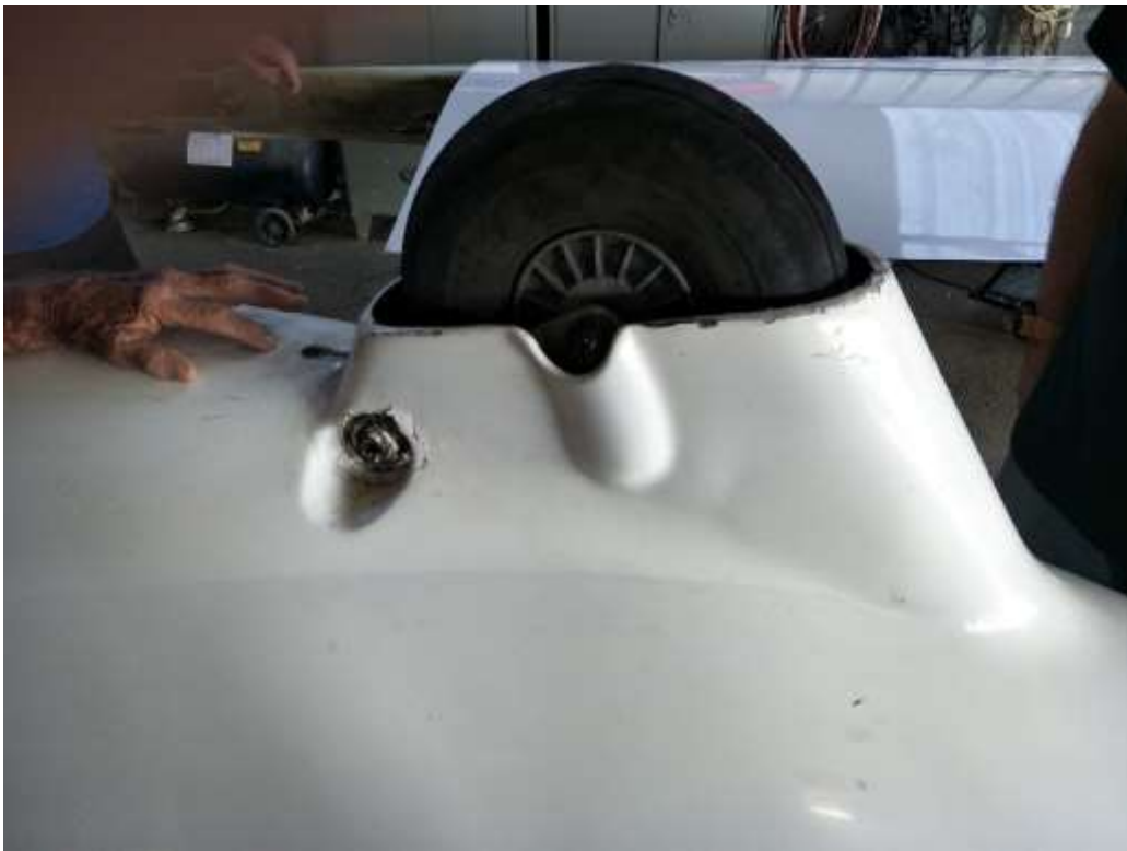
תמונה 5 : המצב הנכון של כן הנסע אחרי החזרת הציר למקומו
