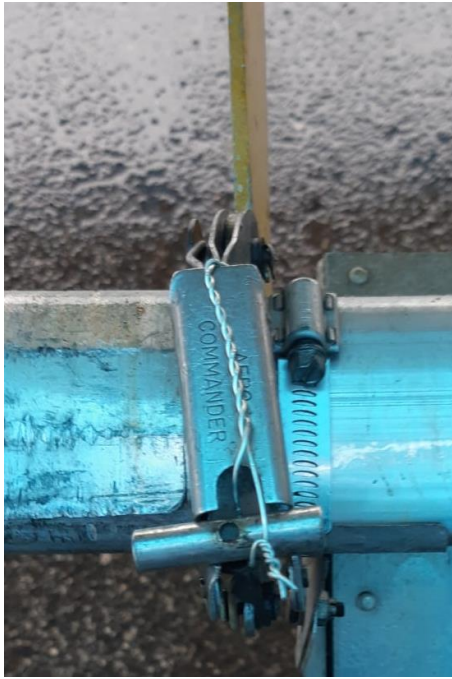
הנעילה הגיאומטרית (ללא הגליל מימין וכפי שהיא אמורה להיות, עם הבוס משמאל)
