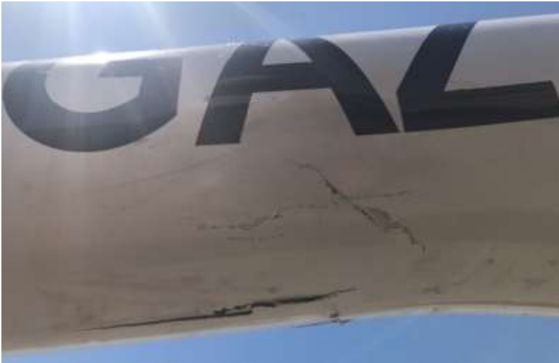
נזק מבני בחלק התחתון של חיבור הדאון למכלול הזנב
